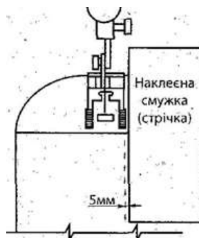
Рис. 20. Зшивання деталей на швейній машині
